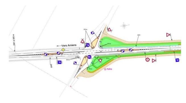
Le carrefour de raccordement entre la RN25 et la RD31 sera aussi aménagé ; l'aménagement existant sera complété par la mise en place d'ilots directionnels bordurés pour améliorer la visibilité du carrefour.
